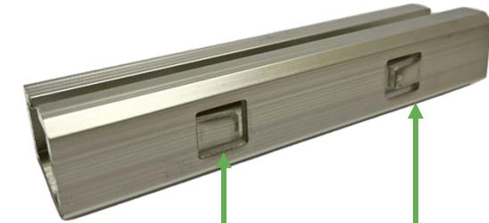
Le connecteur permet de griffer l'intérieur des rails. De ce fait il n'est pas nécessaire de mettre un câble de terre pour chaque rail
